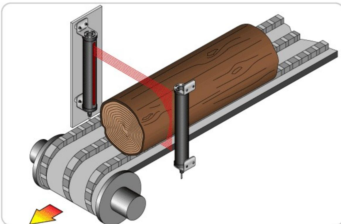
**Модели датчиков:** BEAM-ARRAY - измерительная световая завеса.
