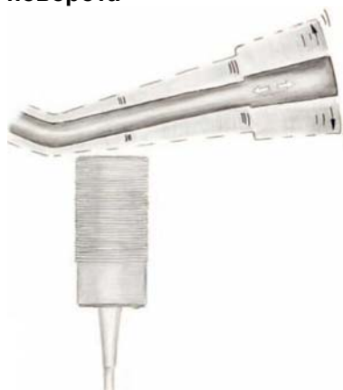
Рис. 4: Аналоговое измерение в автомобильной промышленности, например, положения рычага указателя поворота
