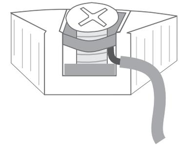
Провод монтируют между пластинами
