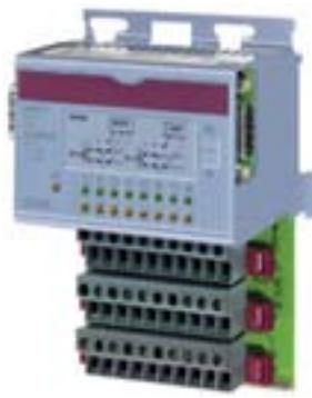
В этом модуле каждый канал можно конфигурировать как вход или как выход. При каждом включении модуля все каналы конфигурированы как входы.
