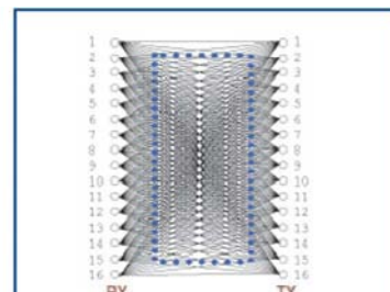
Режим SCAN 3-4: низкая скорость/высокое разрешение мин. детектируемый объект пластина = 0,2 (толщина) x 75 (ширина) мм цилиндрический объект ф 6 мм
