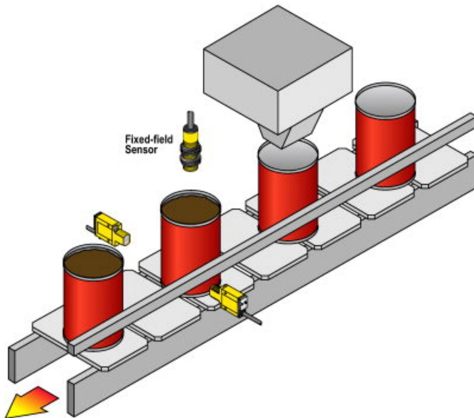
**Компоненты:** оптический датчик серии S18, пара оппозитных датчиков серии MINI-BEAM®.
