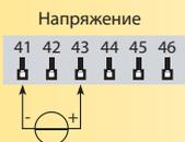
Диапазон измерения ..... -20 mV...12 VDC
