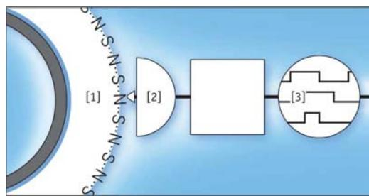
**Путь сигнала:** датчик [2] считывает северные и южные магнитные полюса [1] специально намагниченного ферритового кольца и вырабатывает импульсы, которые после обработки выдаются в виде цифровых сигналов [3] в реальном масштабе времени.
