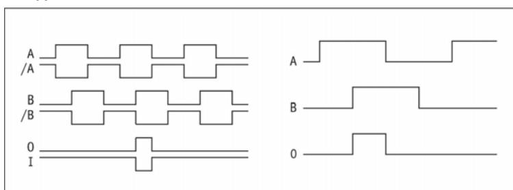
**Логическое состояние сигналов A и B по отношению к опорному сигналу 0 не определено и может отличаться от рисунка.**
