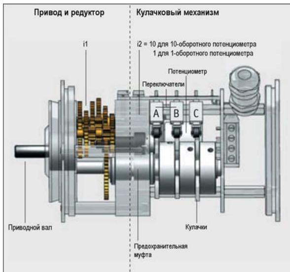
Точная настройка кулачков осуществляется с помощью червячной передачи. Таким путем обеспечивается индивидуальная и точная настройка точки срабатывания.
