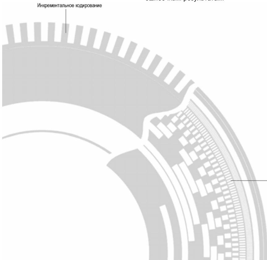
Установленные на оси или шпинделе энкодеры вырабатывают измеряемые значения в виде инкрементальных или абсолютных сигналов. При этом может применяться магнитный или оптический принцип измерения, а также на базе измерения электрического сопротивления (потенциометры с редуктором).
