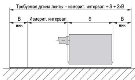
Определение длины ленты (датчик изображен условно)
