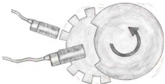
Контроль зубчатого колеса
