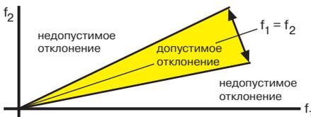
Модуль контроля проскальзывания МК26-22-R является устройством с входными цепями для подключения 2-х-проводных датчиков с токовым выходом (стандарт NAMUR). Модуль предназначен для сравнения последовательностей импульсов при срабатывании датчиков от двух одинаковых по размеру вращающихся частей приводных устройств и позволяет контролировать предельно допустимое проскальзывание в ленточных конвейерах, фрикционных передачах и т.п.
